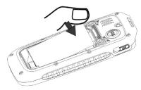
4) Закройте аккумулятор и крепко прижмите крышку. Поверните винты по направлению к знаку «закрыто». Убедитесь, что аккумулятор полностью закрыт.
