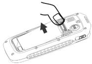
Внимание! Убедитесь, что выключили мобильный телефон, и отключили его от зарядки, перед тем как извлечёте аккумулятор. Используйте аккумулятор предназначенный для данного типа мобильного телефона.
