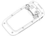
2) Надавите в месте между двумя винтами, как это показано на рисунке, и откройте крышку аккумулятора.
