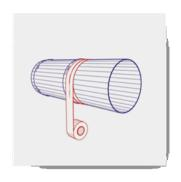
Измерьте толщину стены, раздвиньте телескопический канал установки УВРК-30 на эту длину и зафиксируйте стык между частями с помощью 2-3 слоев скотча.
