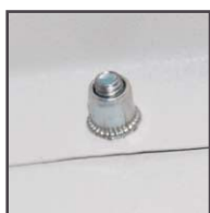
использование резьбовых заклёпок и винтов
